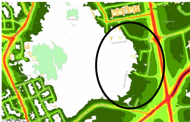
Figur 66; Redovisning av befintligt väg- buller 2011 i dB.
