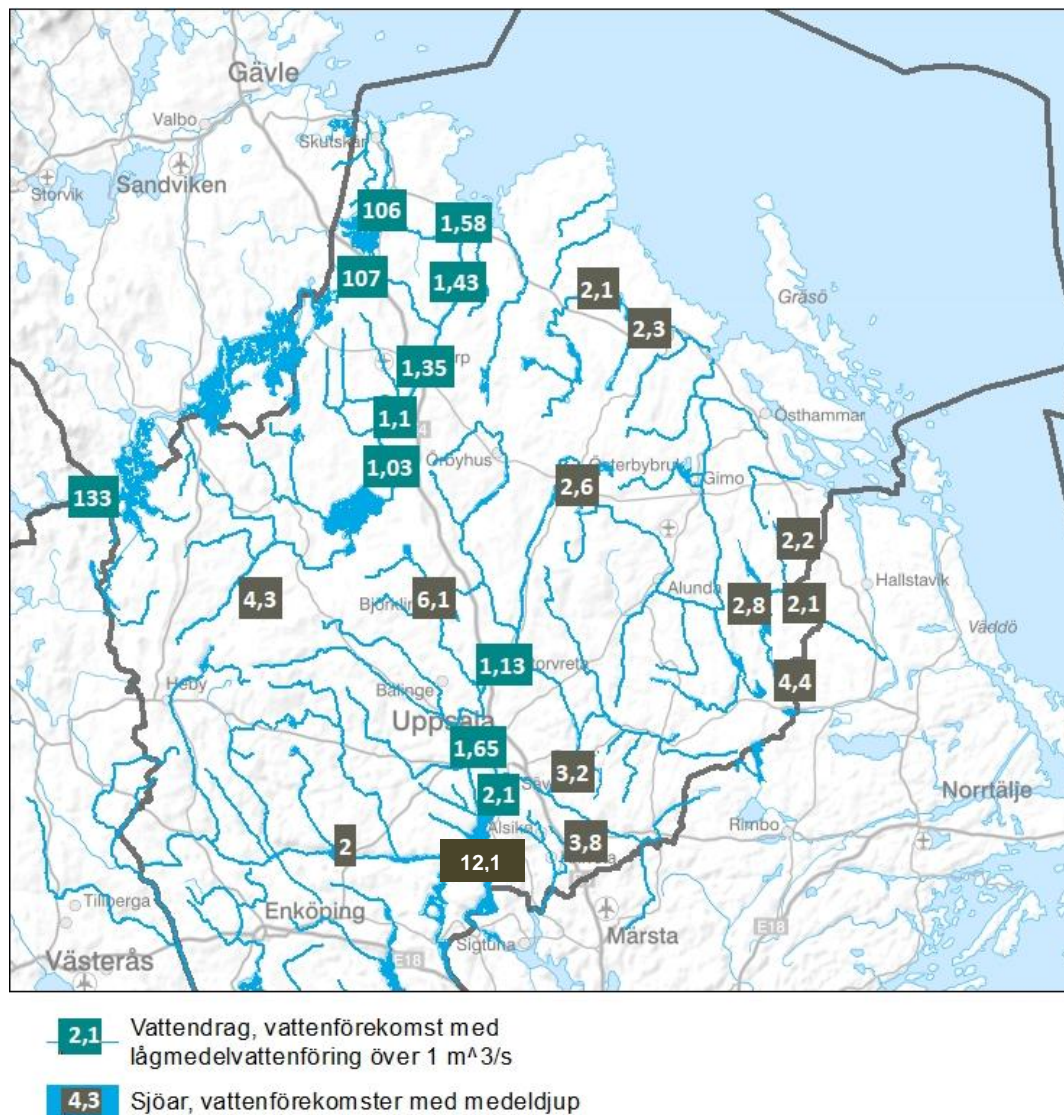
Figur 7: Vattendrag i länet som har en medellågvattenföring som är högre än 1 m 3 /s (grön ruta) och sjöar som har ett medeldjup större än 2 m (grå ruta). Medeldjupet för Mälaren är 12,1 m och är beräknat utifrån hela Mälaren.
