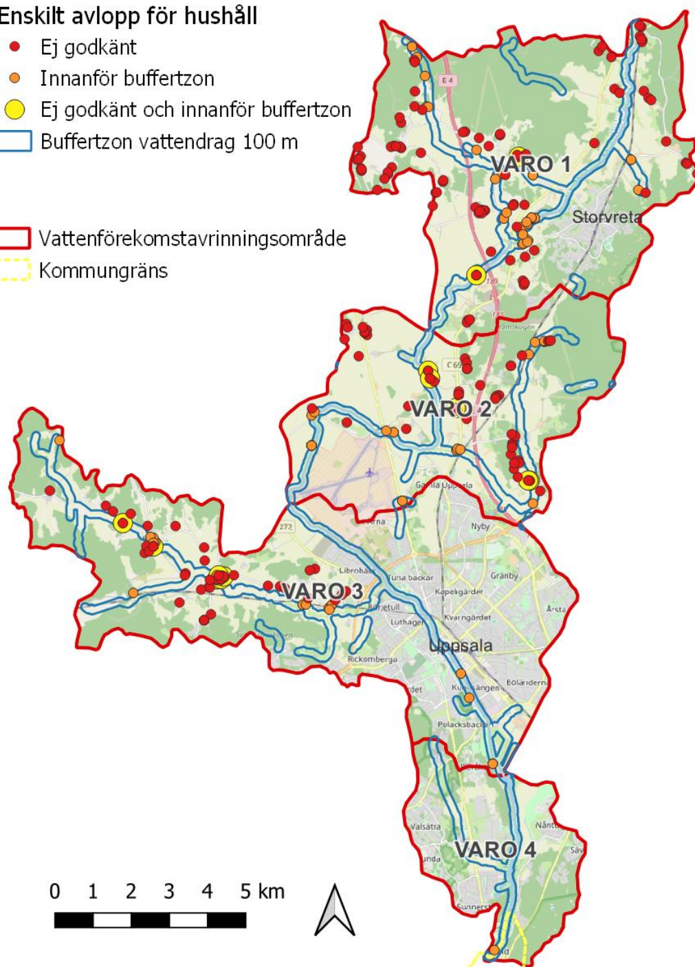
Figur 35. Enskilda avlopp som inte är godkända och/eller ligger mindre än 100 m från Fyrisån eller anslutande biflöden. Ej godkända avlopp nära ån bör åtgärdas snarast, ej godkända längre från ån så snart som möjligt.
