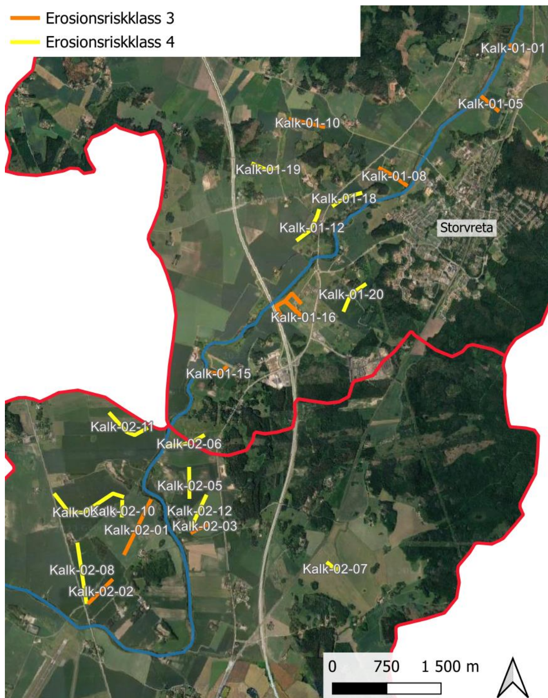
Figur 47. Erosionskänsliga rinnsträckor av riskklass 3 och 4 (vissa sträckor markerade som 4 innehåller kortare sträckor av riskklass 3) i VARO 1 och VARO 2. Potentiella åtgärdsplatser för strukturkalkning är den jordbruksmark som tillrinner rinnsträckan. Observera att strukturkalkning endast är relevant om åkerdräneringen på dessa platser inte fungerar och erosion verkligen sker.
