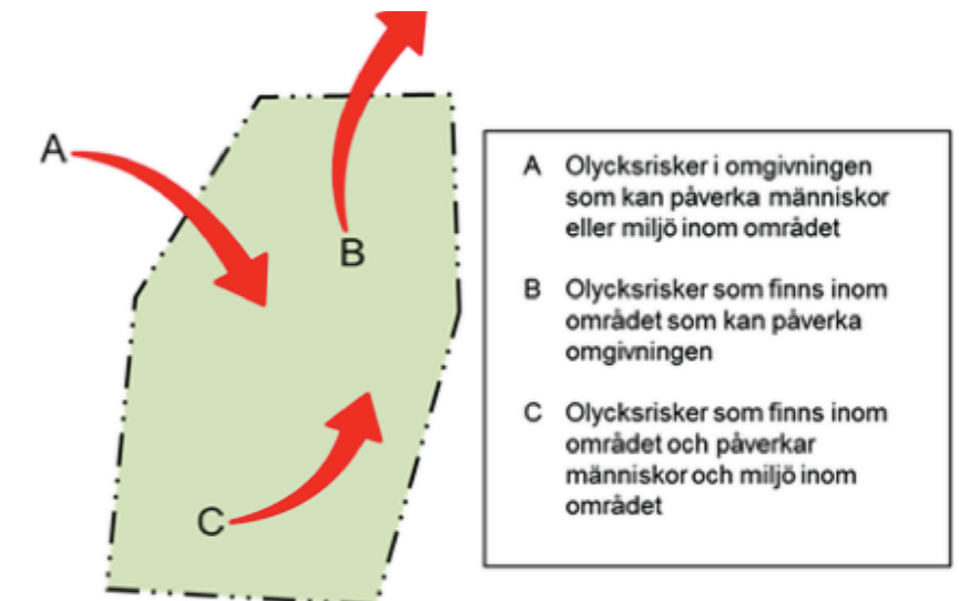
Figur 57. En illustration av de tre olika perspektiv som används vid riskidentifiering
