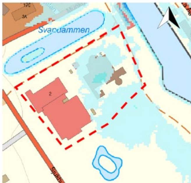
Figur 41 - Utdrag ur dagvattenutredningen för beräknat klimatanpassat 100-årsflöde, Structor.
