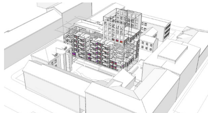
Geometrimodellen illustrerar den tidiga simuleringen då balkonger fanns representerade. Skuggande volymer är representativa i samtliga analyser.
