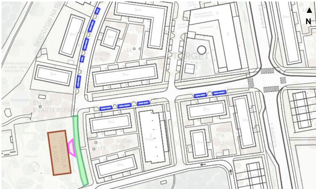
Figur 25 Angöring för Förskola 1. Blå markering visar hämta/lämna, rosa markering visar parkering för rörelsehindrade och grön markering visar angöringsgata. (Bakgrundsbild: Illustrationsplan, 2026)
