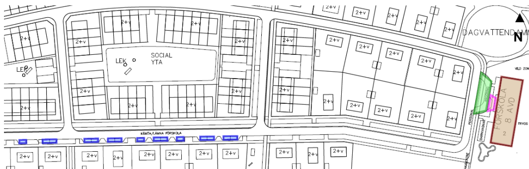
Figur 26 Angöring för Förskola 2. Blå markering visar hämta/lämna, rosa markering visar parkering för rörelsehindrade och grön markering visar där angöring utan backning kan ske.
