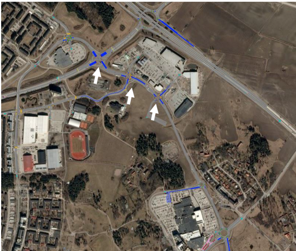
Figur 17. Simulering av trafiken och graden av köbildning vid tömning av arenan efter ett evenemang med 5 000 besökare prognosår 2040, och där ett antal cirkulationsplatser ersatts med trafikljusreglerade fyrvägs korsningar. Bild Ramboll.
