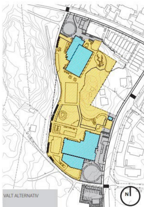
Karta över skolgårdens ytor, där fria ytor redovisas som gult, byggnader som blått och trafikzoner som grått, PE Teknik & Arkitektur.
