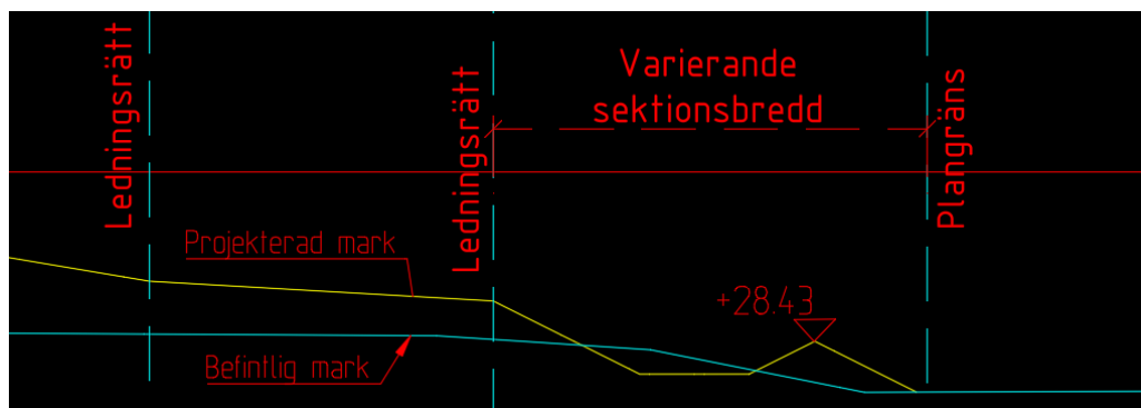
Figur 3. Principsektion för diket sett söderifrån. Projekterad mark gäller för planområdet. Ungefärlig befintlig marknivå visas för fastigheten Bälinge-Ekeby 1:2 till höger om plangräns.
