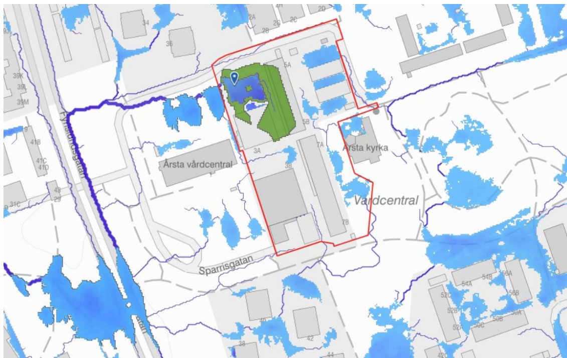
Figur 16. Avrinningsområde (grönt område) till befintlig lågpunkt inom planområdet enligt Scalgo Live. Plangräns markerad med röd linje.
