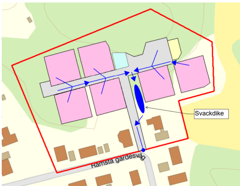
Bild 19 Illustration över föreslagen hantering av dagvatten. Bilden visar förslag till ytliga rinnvägar och fördröjning via svackdike.
