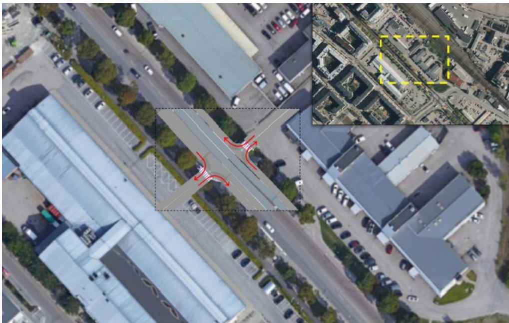
Figur 44. Utformning med höger in/höger ut för fastigheterna på båda sidor om Kungsgatan. I analysen har båda fastigheter tagits med men detaljplanen reglerar enbart ny utfart för fastigheten Kungsängen 29:1, som ligger på östra sidan Kungsgatan. Källa: WSP.
