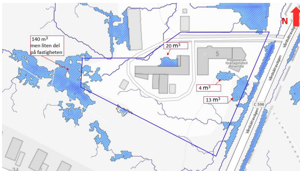
Figur 40 Lågpunktskartering i Scalgo Live. Blå ytor indikerar lågpunkter som kan fyllas med vatten. Mörkblå smala linjer är rinnvägar i befintlig terräng. Källa: Ramböll AB.
