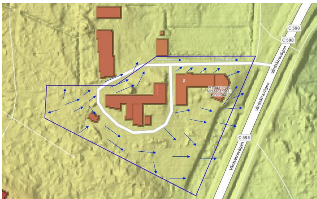
Figur 35 Bilden visar befintlig avrinning. Blå pilar visar befintliga rinnvägar för ytvatten. Källa: Ramböll AB.
