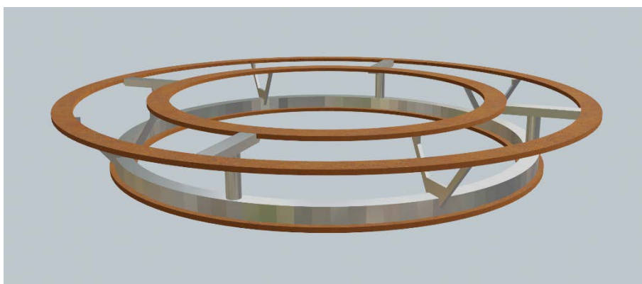
Ringar av cortenstål monteras med bultar i gängade hål i det rostfria
