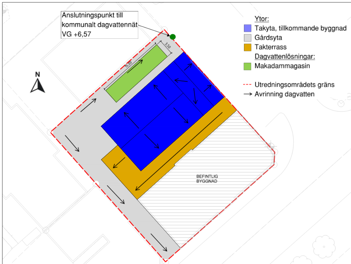
Figur 15. Föreslagen systemlösning för dagvattenhantering inom utredningsområdet. Ytor och dagvattenanläggningar är färgsatta på samma sätt som flödesschemat i Figur 14.
