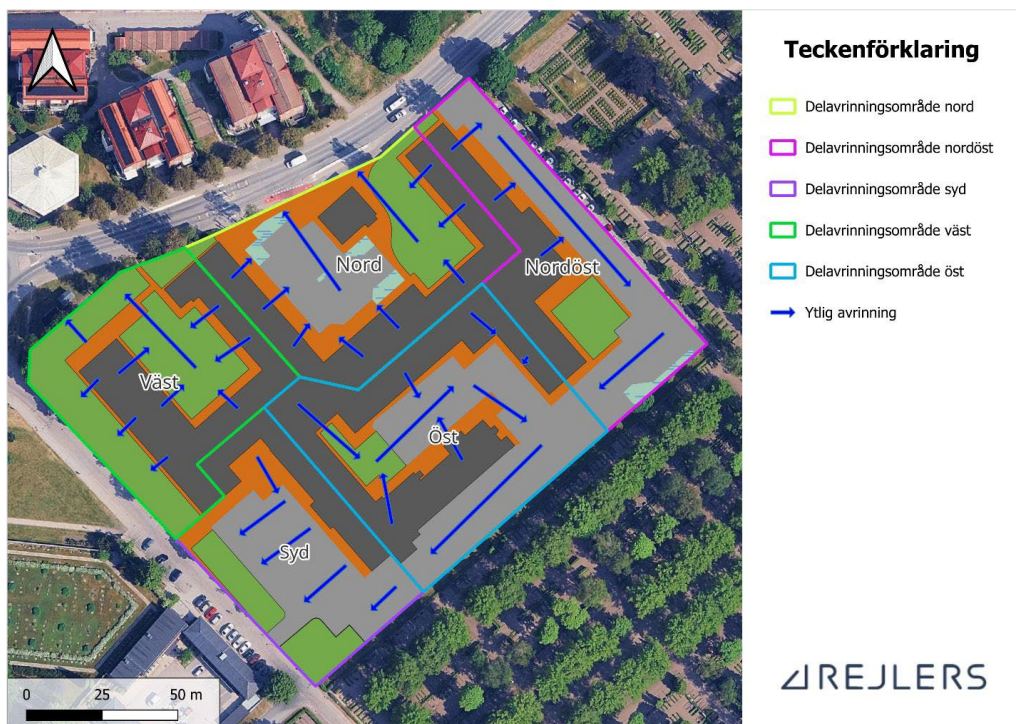
Bild 85. Illustration som visar de föreslagna delavrinningsområdena med den planerade markanvändningen. De blå pilarna visa riktningen för den ytliga avrinningen. Illustration: Reillers
