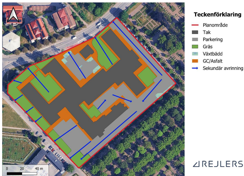
Bild 90. Illustration som visar den föreslagna markanvändningen. De blå pilarna visar de sekundära avrinningsvägarna. Illustration: Reijlers
