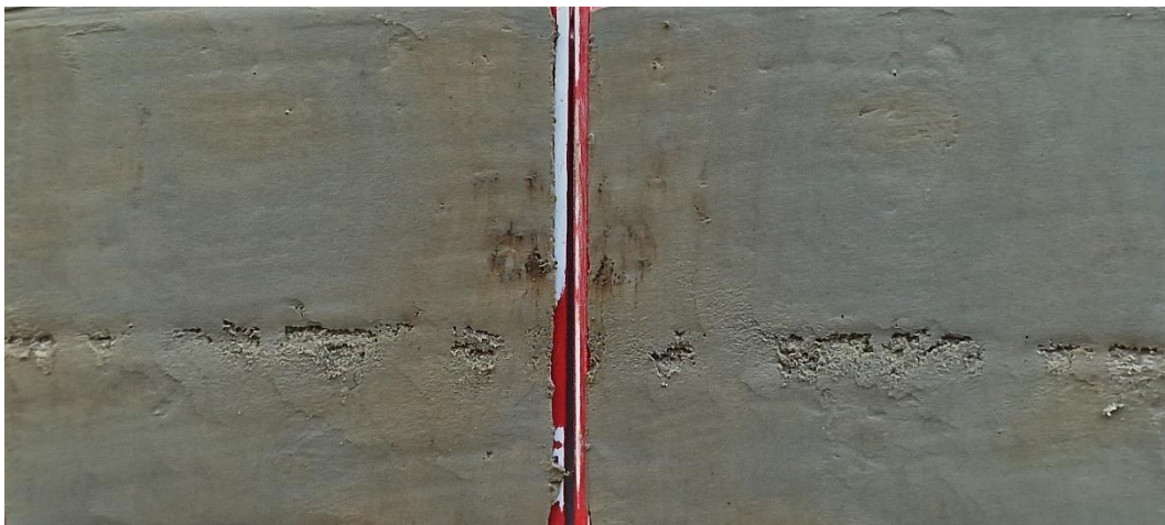
Figur 1 Borrpunkten, 23B01, 2,5 m, Jordprovet i nedre delen av mellanhylsan delad longitudinellt provhylsan med id Bjerking 1383.
