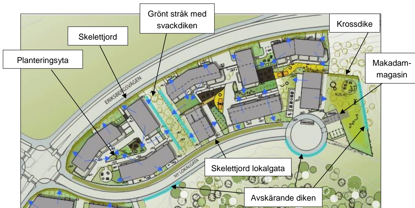
Figur 11. Föreslagna dagvattenlösningar på Wallenstams fastighetsområde samt på förskoleområdet. Planteringsytor med infiltration visas med grön färg. Dagvattenlösningar är ungefärligt ritade efter åtgången area. Rinnriktningar för dagvatten visas med blåa pilar.
