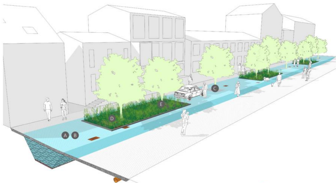
Figur 12. Exempelbild på sektion med luftigt förstärkningslager (cyan) längs med gata. Marken ovan förstärkningslagret kan förses med hårdgjorda ytor, träd eller annan vegetation och är därmed anpassningsbar. Bild tagen från Levande gaturum – en handbok i blågröngrå system , Edge och Uppsala kommun.
