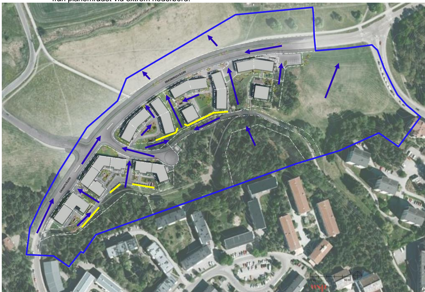
Figur 16. Översikt över de huvudsakliga lågpunktslinjerna inom planområdet utmarkerat med blåa flödespilar. Gul markering visar förslag på avskärande dike. Planområdesgränsen visas med mörkblå linje. Illustrationsplan WSP, 2020-12-14.
