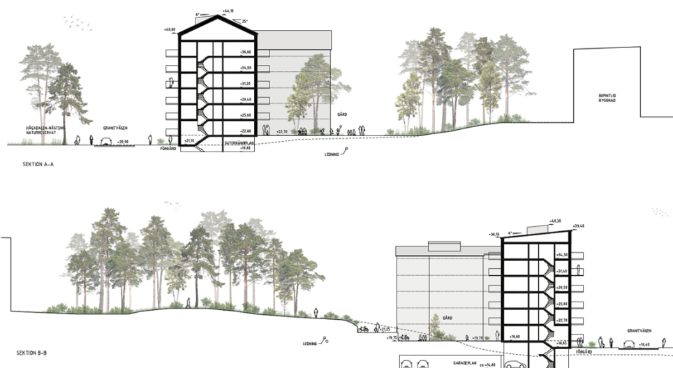
Bild 21 Sektioner (A-A, och B-B) som visar hur bebyggelsen förhåller sig till befintlig bebyggelse och hur den trappas ned mot Ekebydalen. (Bernow & partners).
