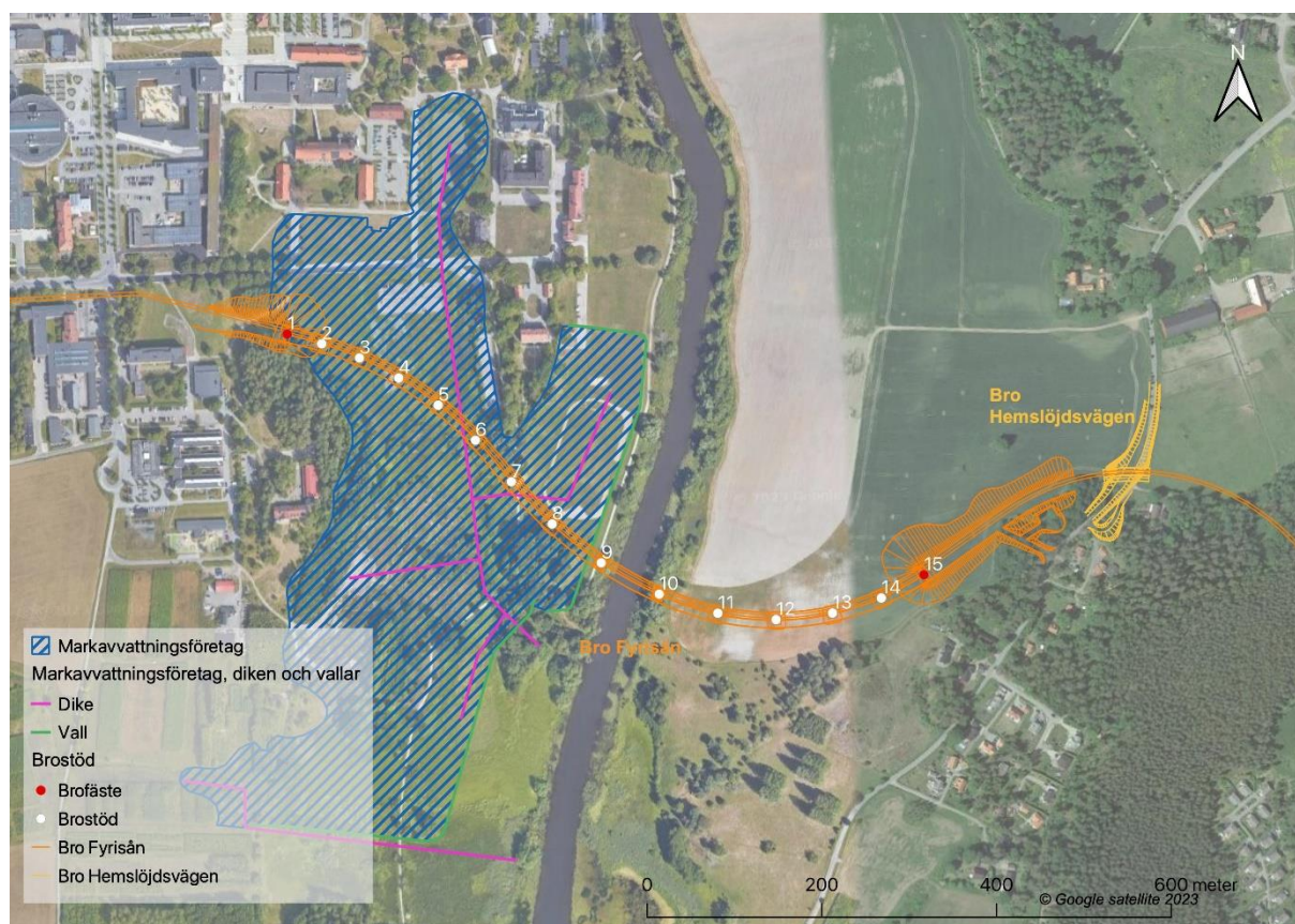
Figur 3. Markavvattningsföretag Ultuna invallningsföretag. Brostöd nr 6 anläggs troligtvis i dike till och brostöd nr 9 i invallning till markavvattningsföretaget. Inmätning av dike och vall ska utföras.
