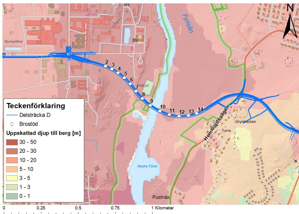
Figur 17. Jorddjup från SGU och spårsträckning.
