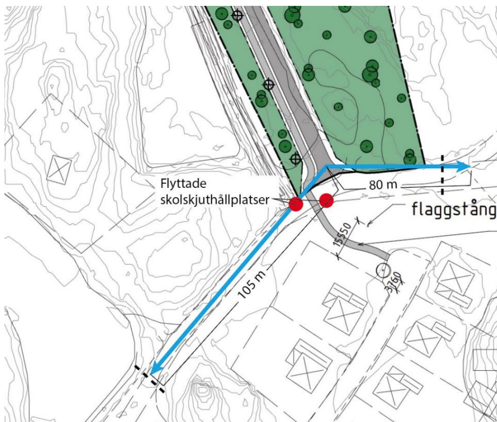
Bild 25 Anslutningsvägen ska uppnå fri sikt enligt VGU (blå pilar). Bilden visar att fri sikt uppnås i väster men i öster krävs åtgärder för att uppnå fri sikt (streckade linjer). Bilden visar också förslag på flyttat läge för skolskjuts (röda prickar). Bjerking AB. Underlagsillustration Lars Hallgren Arkitektkontor AB.
