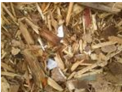
Bild X Träavfall används som bränsle för produktion av el och fjärrvärme, bild från Ena Energi i Enköping.
