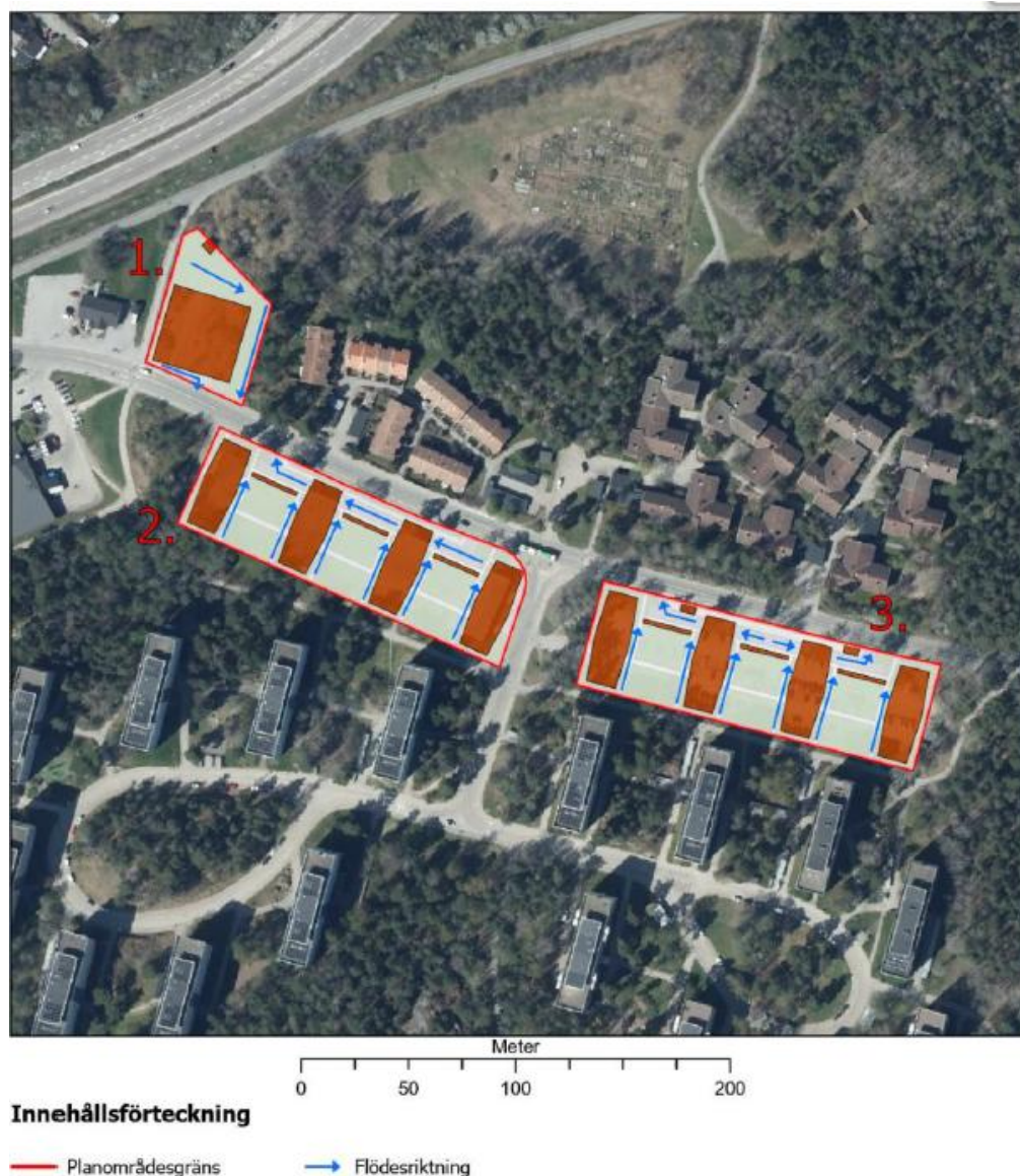
Figur 30 Utdrag ur dagvattenutredningen. I område 1 (mobilitetshuset) lutar befintlig mark mot nordväst. Flödesriktningen i kartan utgår fram att höjdsättningen efter exploatering förändras.
