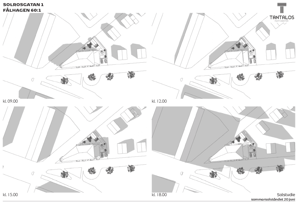
Figur 31. Solstudie som visar hur den nya byggnadens skugga faller vid sommarsolståndet. Källa: Torget Arkitekter
