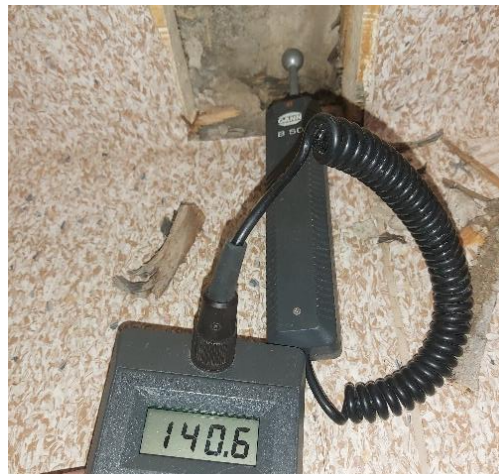
Foto 10 kraftigt förhöjda skalutslag mot källarvägg
