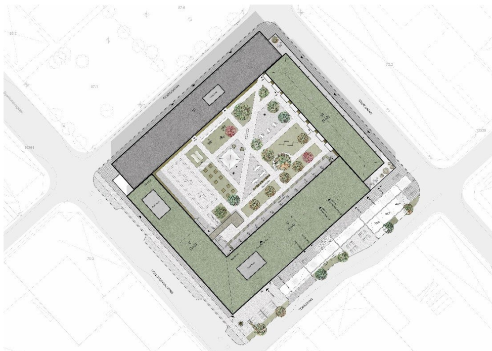
Figur 17 Illustrationsplan som visar utbredningen av påbyggnaden mot Sturegatan samt möjlig utformning av bostadsgården.
