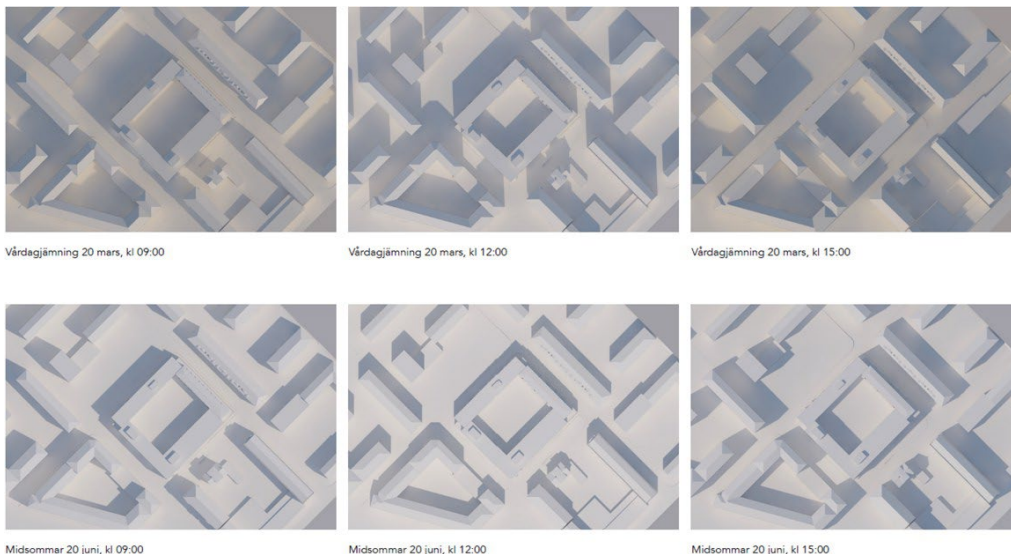
Figur 26 Sol- och skuggstudie som visar skugga på gården. Övre raden visar den 20 mars klockan 9, 12 och 15. Undre raden visar den 20 juni klockan 9, 12 och 15. Observera att volymen avsedd för hiss på gården inte finns med i bilderna, SK-R Arkitekter.
