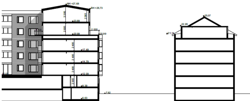
Figur 13 Sektion genom den indragna påbyggnaden mot Sturegatan. Befintlig byggnad, Torsgatan 8, till höger. SR-K Arkitekter.
