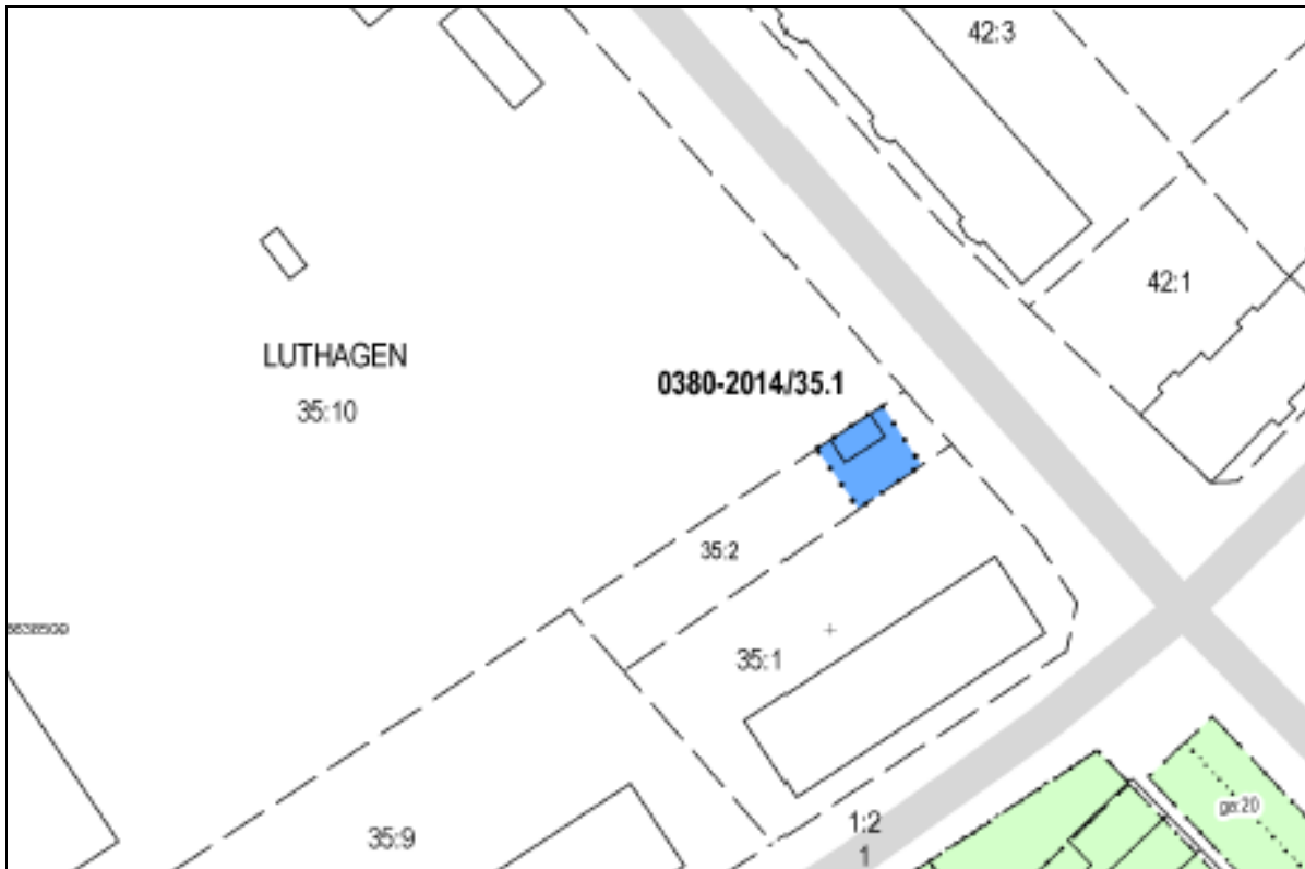
Utdrag från förättningskartan avseende ledningsrätt för nätstationen på fastigheten Luthagen 35:2.
