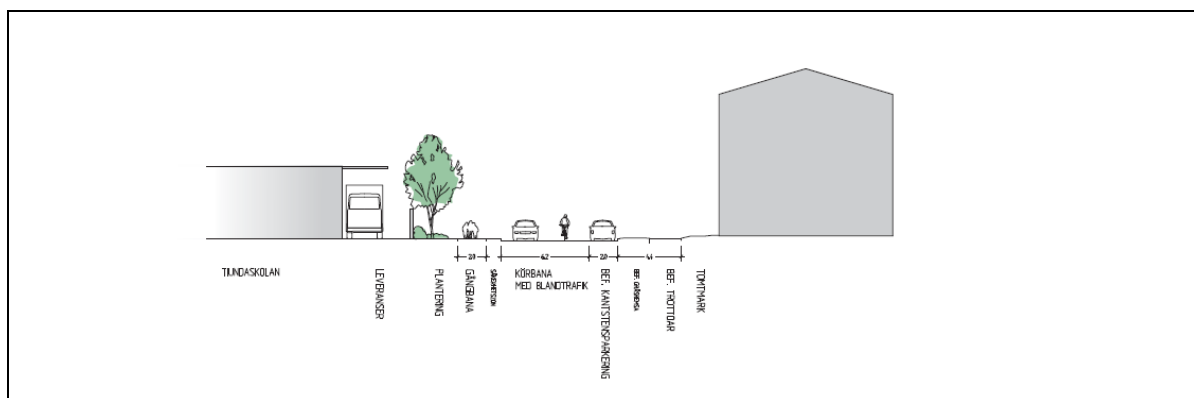
Sektion för Sibyllegatan vid angöring för leveranser till och från köket (Sweco Architects).
