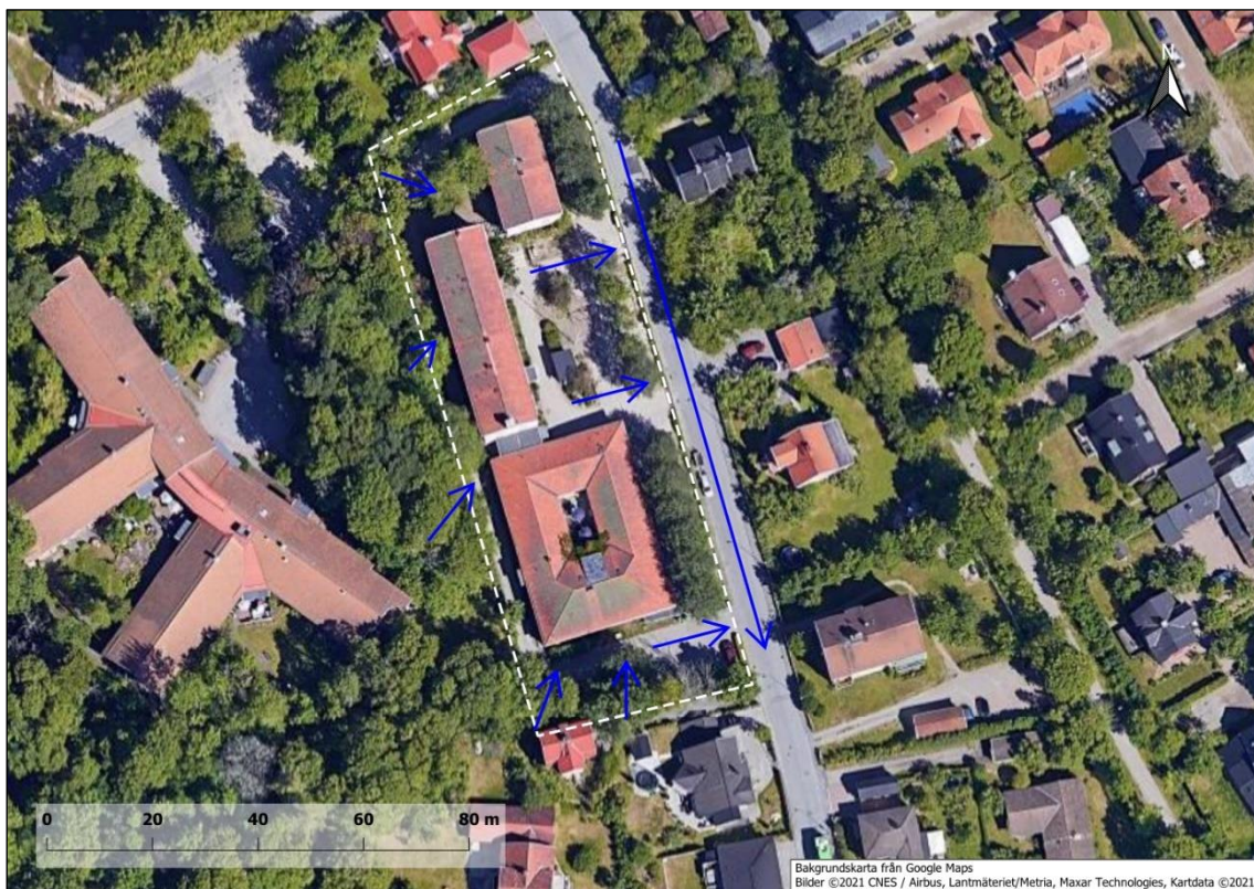
Figur 4-7. Befintliga ytliga avrinningsvägar inom och uppströms utredningsområdet. Utredningsområdesgränsen visas med en vitstreckad polygon.
