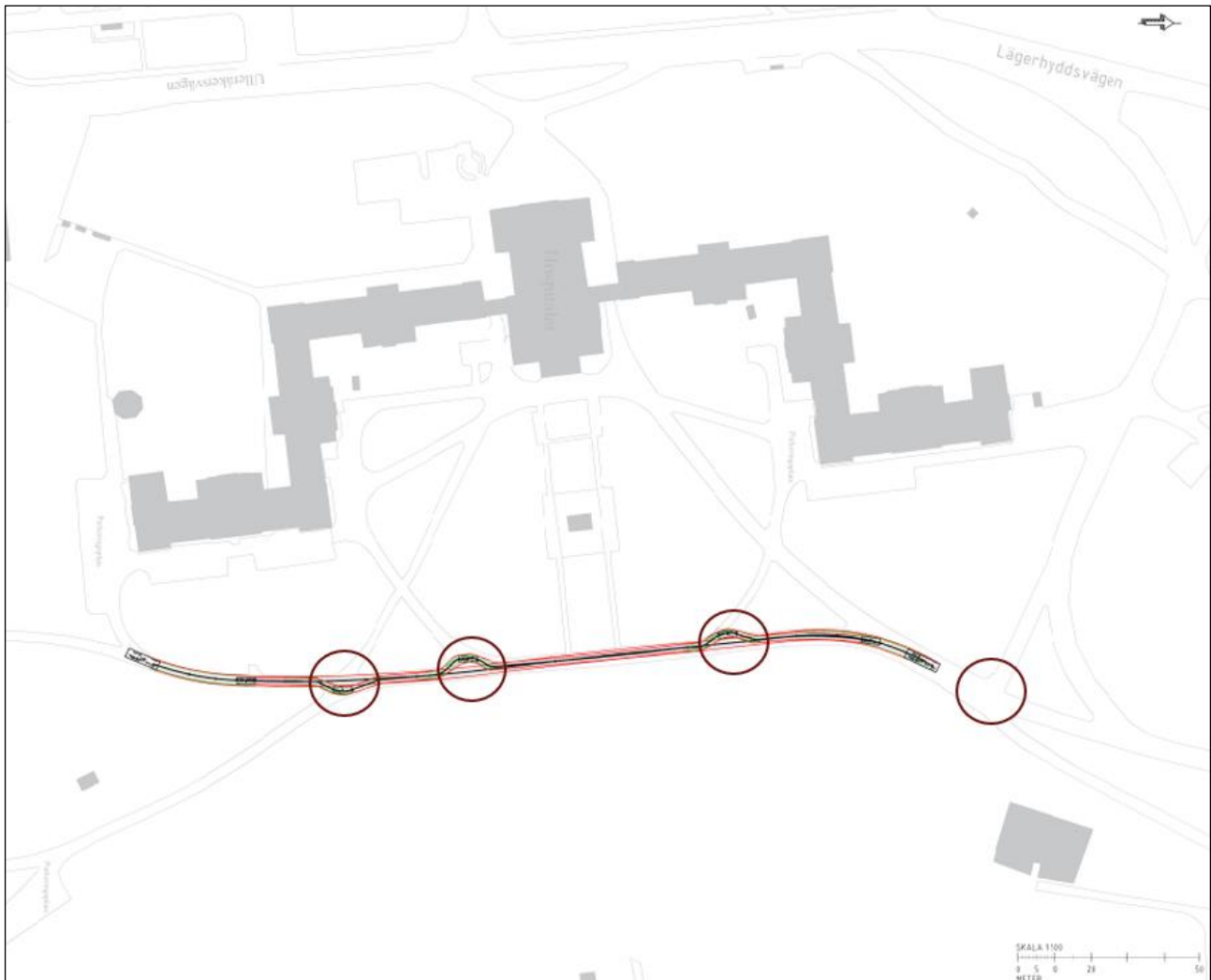
Figur 15. Möjliga mötesplatser längs dubbelriktad sträcka av föreslagen angörings slinga. Körspår har gjorts med Trafikverkets typfordon LOS och P.
