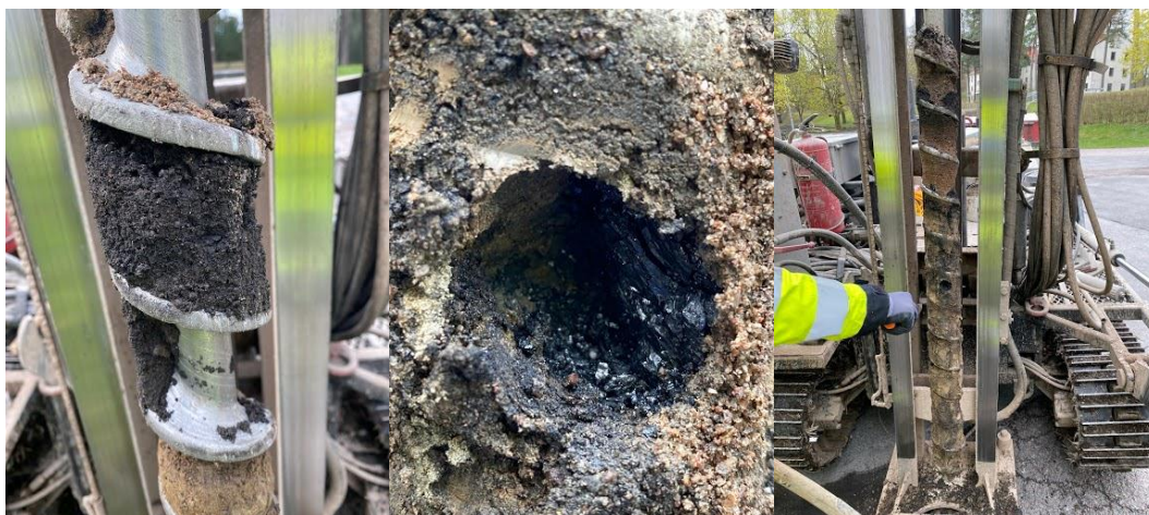
Figur 4: Bild på provskruven från provpunkterna vid troliga kolupplaget direkt väster om byggnaden. Till vänster är en bild på översta delen av SW21-03 (0-0,3 m). Mitten- och högerbilden är från översta metern av SW21-01. I mitten är en närbild av ett fynd av vad som ser ut att vara en bit stenkol vid cirka 0,5 meters djup.
