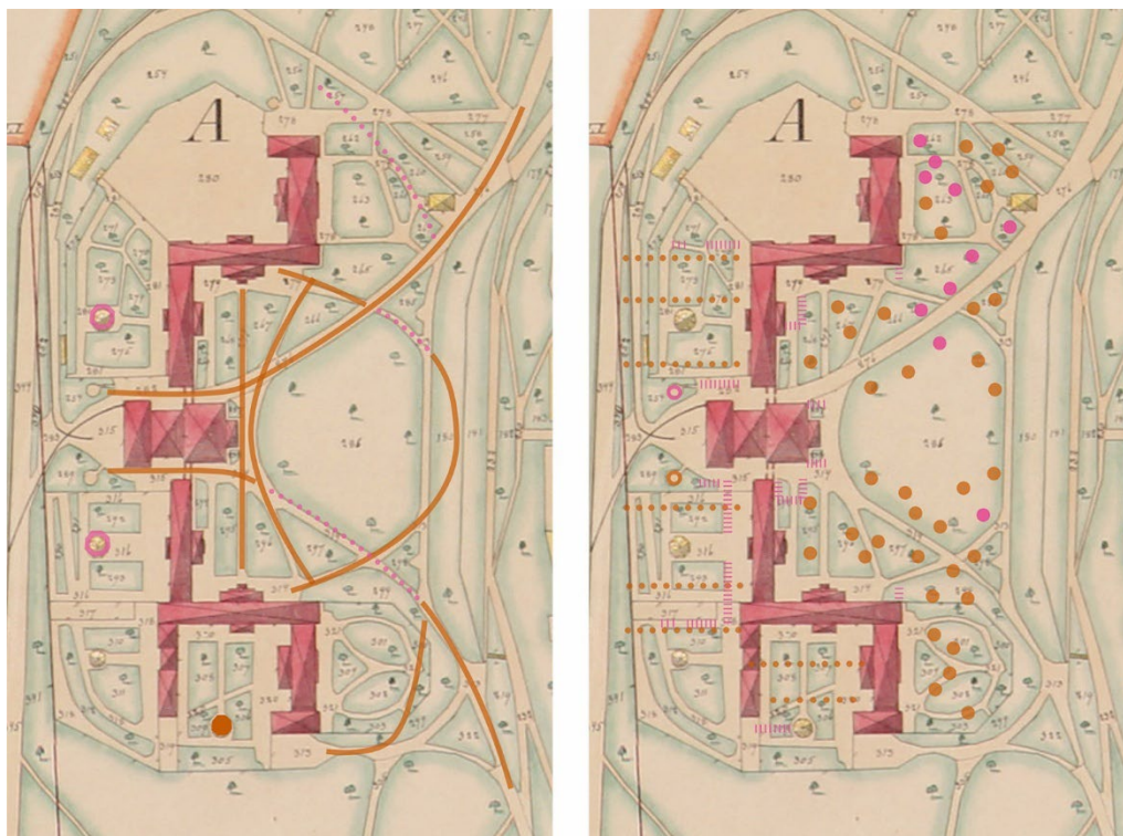
Bild 39 Till vänster: Vägledning för utveckling och återskapande av parkstrukturer, överlagrat på karta från 1911. Orange = befintliga gångvägar och paviljonger. Rosa = föreslagna återskapade gångvägar och paviljonger. Till höger: Vägledning för vegetation, överlagrat på karta upprättad 1911. Orange = befintliga träd, bersåer och riktningar för plantering. Rosa = föreslagna träd, bersåer och häckar. Ur Gestaltningssprogram för allmän plats, Nivå Landskapsarkitektur
