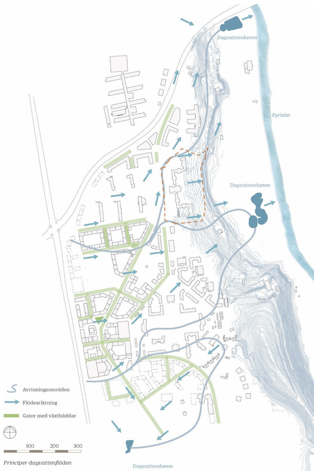
Bild 56 Principer för dagvattenflöden i Ulleråker. Planområdet avrinner mot den norra dagvattendammen. Illustration: Nivå landskapsarkitektur
