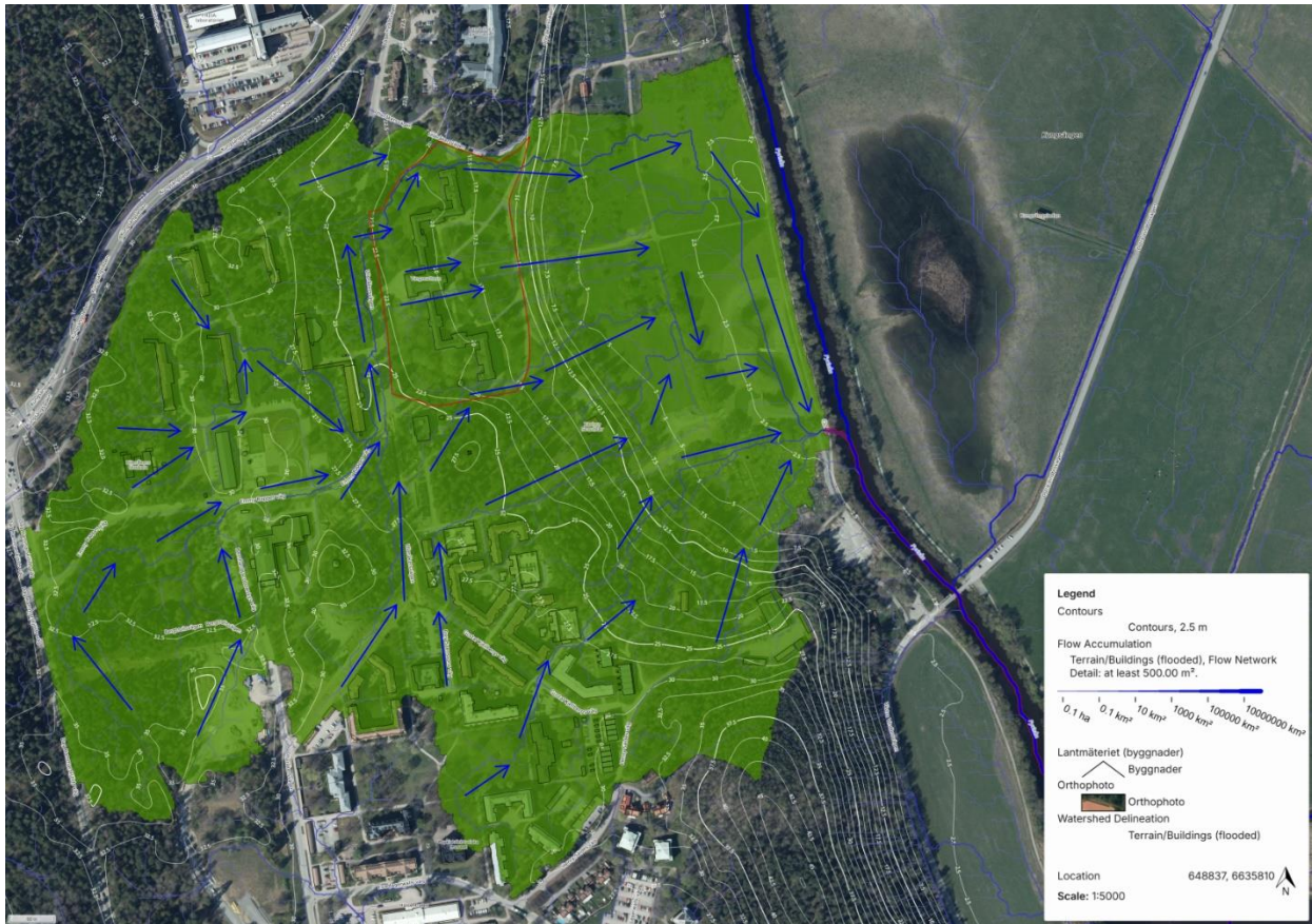
Figur 6. Delavrinningsområde till Fyrisån, vilket utredningsområdet är beläget inom. Inom utredningsområdet ligger även Tallstråket samt delar av Norra och Centrala Ulleråker. Bilden är framtagen i Scalgo Live med funktionen depression free flow, vilket innebär att flödesvägar visas för ett scenario där vatten fyller upp alla lågpunkter i terrängen och tillåts rinna vidare. Röd linje markerar utredningsområdet ungefärliga gräns. Blå pilar visa flödesriktning. Bildkälla: Scalgo Live.
