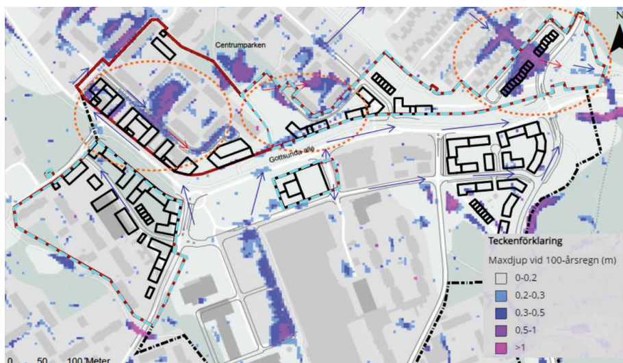
Figur 41. Skyfallskarteringen baseras på befintliga markhöjder. Detaljplanegränsen är markerad med turkos streckad linje. Den föreslagna nybyggnationen är inritad med tunna svarta linjer. Blå pilar visar sekundära flödesvägar. Röda pilar visar rinnvägar där en viss tröskelnivå behöver uppnås för att vattnet ska kunna rinna vidare söderut (Uppsala kommun, 2020).
