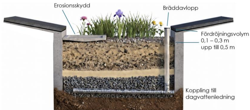
Principskiss för nedsänkt växtbädd med ytlig fördröjningsvolym och dränering
