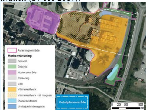
Bild från dagvattenutredningen: ”Markanvändning efter exploatering. De korsande orangea linjerna representerar området vars dagvatten rinner till magasinet.”
