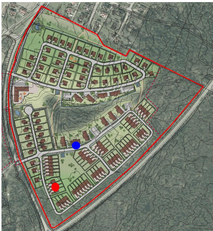
Figur 10. Blå cirkel avser ungefärligt läge för punkt där grundvattennivå är uppmätt till 1,3 m under markytan medan röd cirkel visar högsta grundvattennivå, ca 1,2 m under markytan, under fältbesök av Bjerking 2023-06-30.
