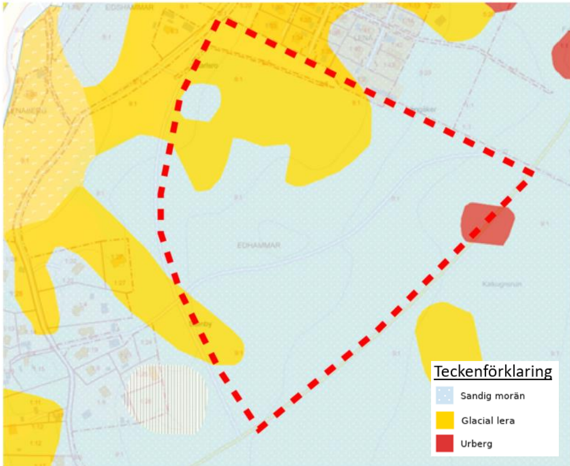
Figur 7. Jordarter inom utredningsområdet. Planområdet är beläget på morän och lera. © SGU Hämtad från Bjerking's kartportal. Planområdets ungefärliga utbredning och position markerad med röstreckad linje.
