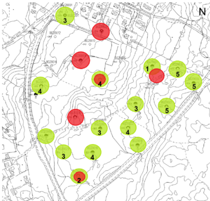
Figur 20 Bilden visar ungefärlig presentation av infiltrationsmöjligheter inom området. God möjlighet till infiltration visas med grön punkt, röd punkt redovisar en sämre infiltration den översta halvmetern som är mer finkornig jord. Dubbla cirkelar visar att det finns god möjlighet för infiltrering men har låg kapacitet.
