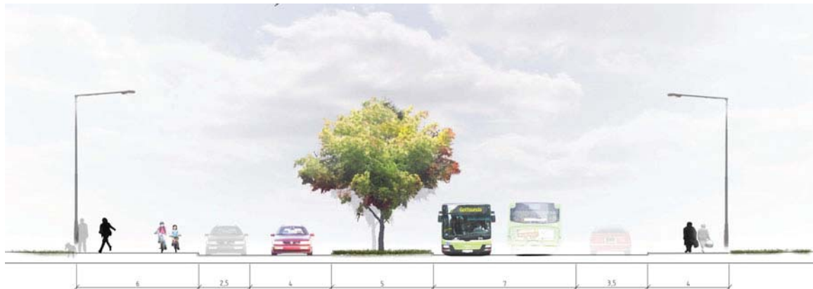
Föreslagen gatusektion för Kungsängsesplanaden. Befintlig trädrad sparas och stomlinjer kör i mitten av gatusektionen, enfiliga körbanor för biltrafik anordnas samt dubbelriktade gång- och cykelvägar på båda sidor om gatan, Ramböll
