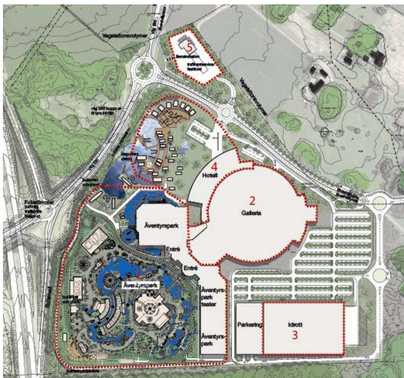
Situationsplan som visar de olika delarna i projektet Fullerö Park med tillhörande allmänna vägar (1=temapark, 2=galleria, 3=sportshall, idrottshall, 4=hotell, 5=trafikantservice)
