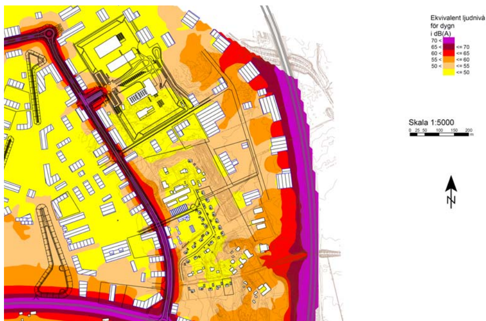
Bullerkarta som visar bullernivån (2 meter över mark) för befintliga och planerade bostäder vid fullt utbyggt område med planerade bullervallar. Riksdagens riktvärden för nybyggnation av bostäder är 55 dB(A) ekvivalent ljudnivå. Illustration: ÅF Ingemansson.
