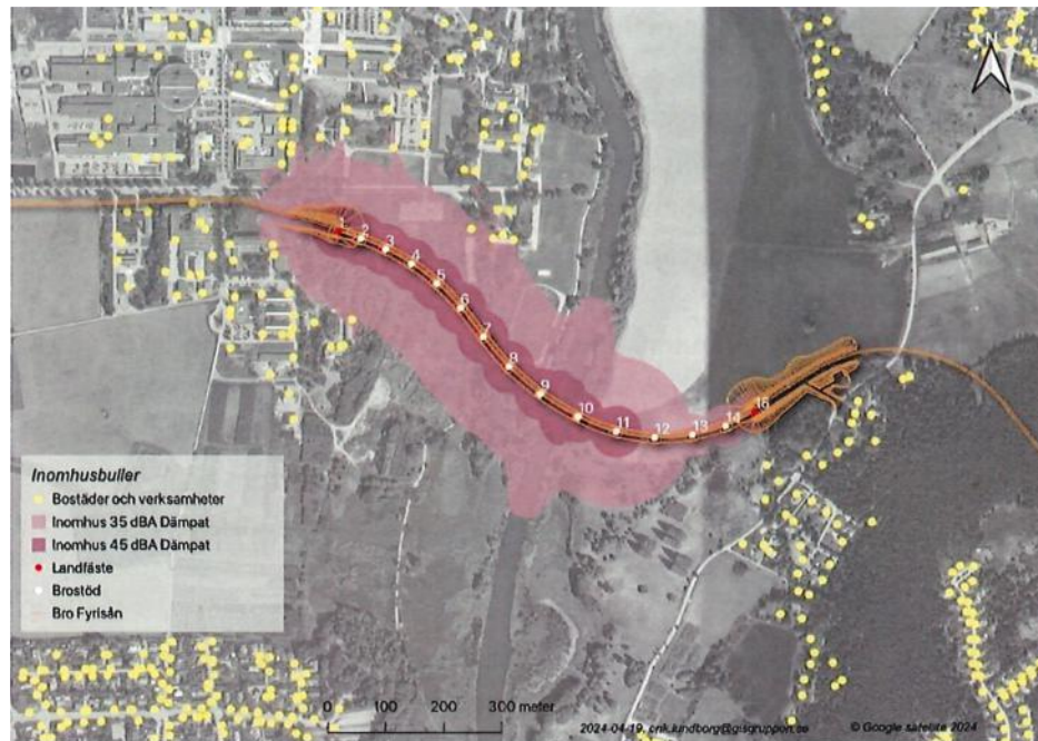
Figur 14. Bullerutredning vid dämpad påslagning för brostöd 1-11 och borring för brostöd 12-15, 70 dBA ekvivalentnivå utomhus vid fasad/45 dBA ekvivalentnivå inomhus gäller för bostäder helgfri mån-fre mellan 07-19. Riktvärdet 45 dBA ekvivalent nivå inomhus för bostäder överskrids inte. De arbeten som alstrar denna bullerutbredning får ske den 1 september — den 31 mars, restriktionen gäller med hänsyn till fåglar och fladdermöss.
