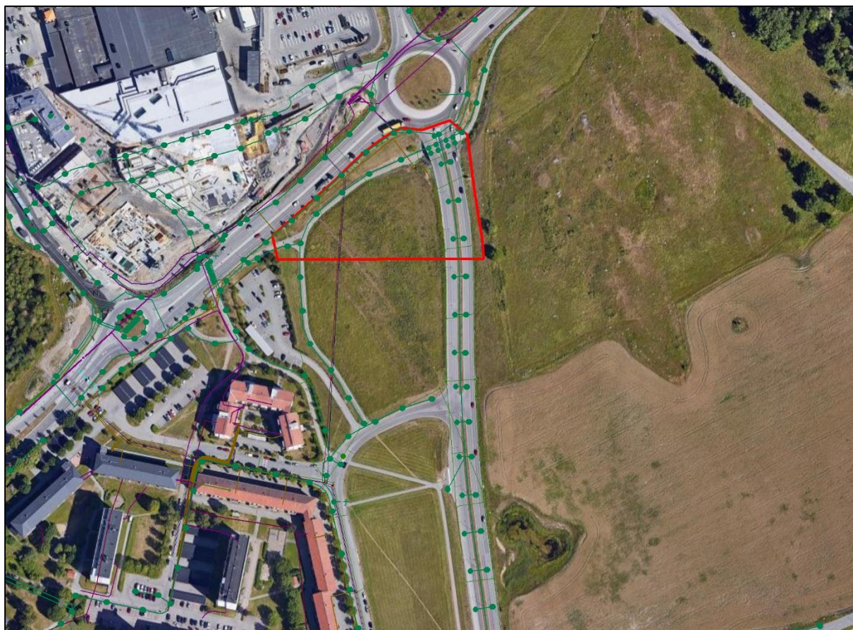
Figur 3-4. Dagvattenledningar och andra ledningar i området. Gröna linjer och punkter anger dagvattenledningar och brunnar. Ledningskartan har erhållits från beställaren. Etapp 3B är markerat med en röd polygon.
