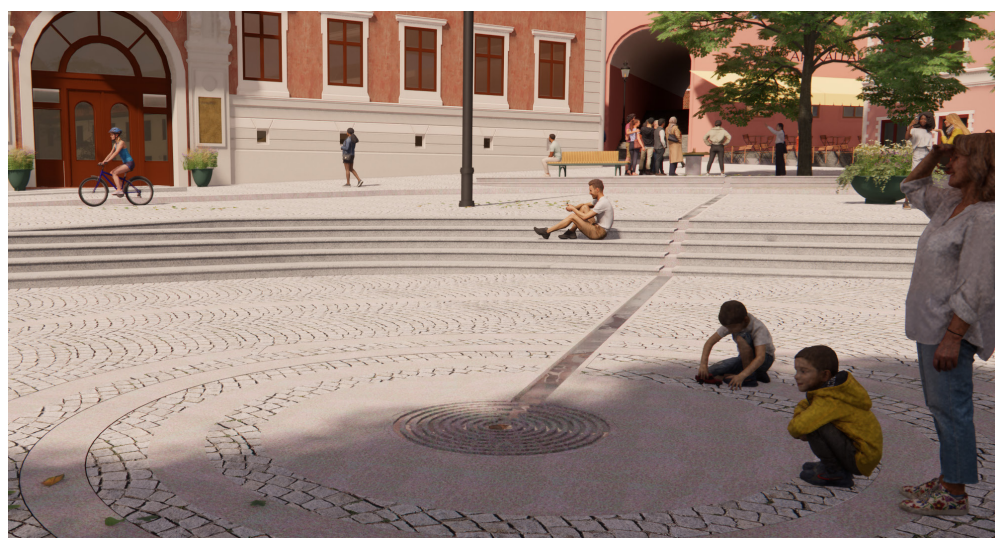
3D vy: Exempel på grund dagvattenränna och uppsamlade yta där en grund vattenspegel bildas i en mönsterhuggen granitplatta.
