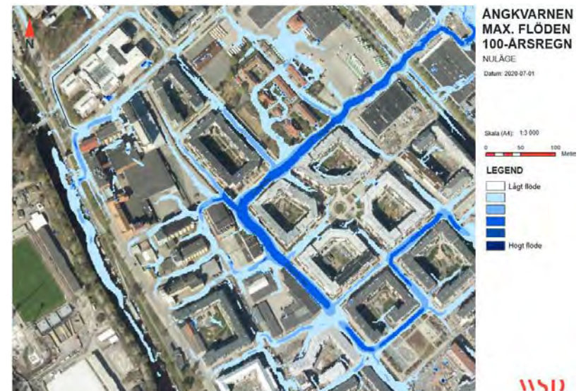
Figur II: Flödesvägar vid befintligt scenario.
