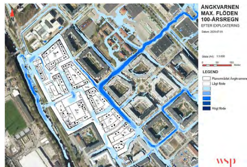
Figur IV: Flödesvägar med ny planerad exploatering för Ångkvarnen
