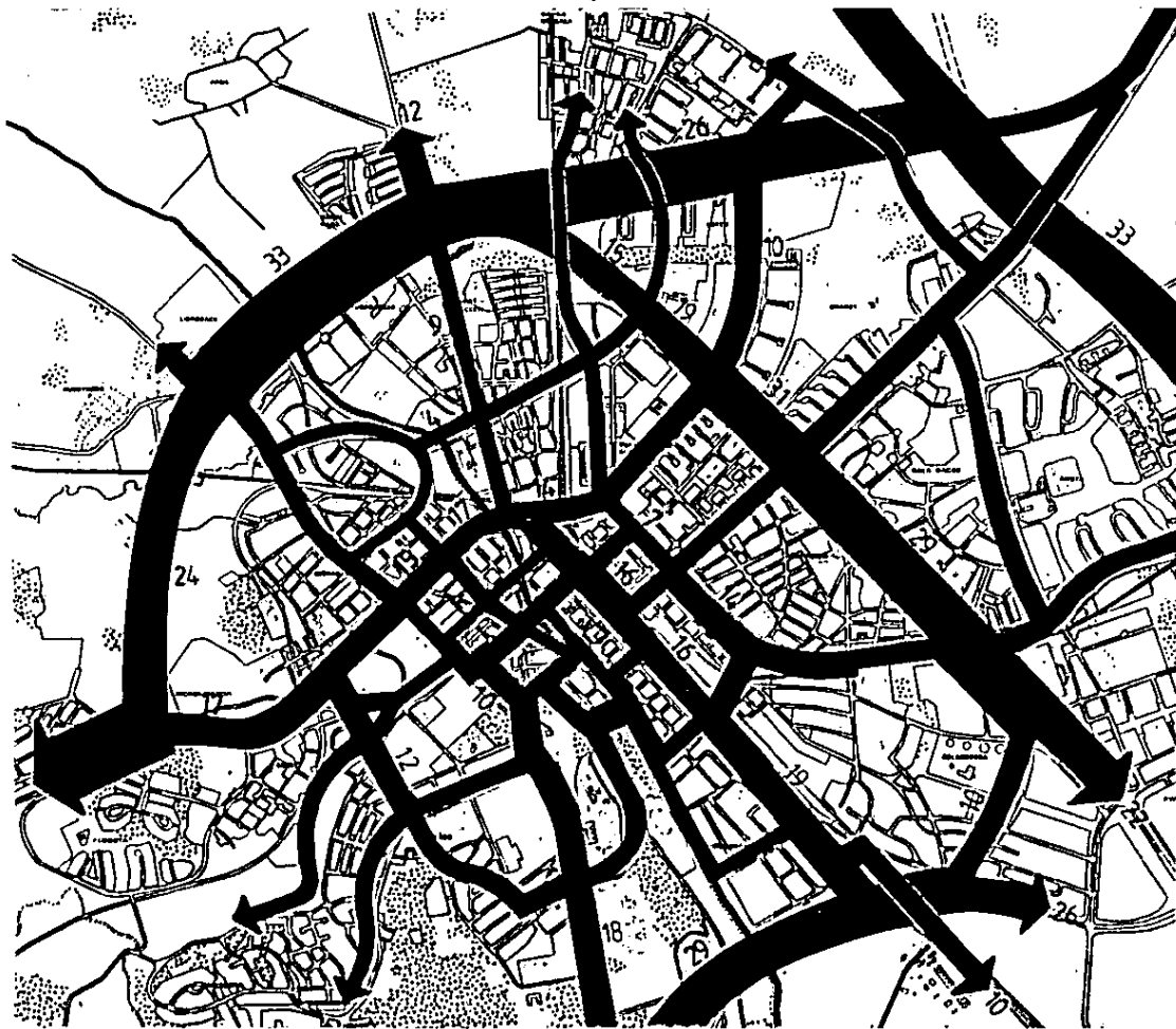
Beräknad trafik år 2010 med Bärbyled II och III och ny E4 (Alt Årsta) (1000-tal fordon/dygn)
