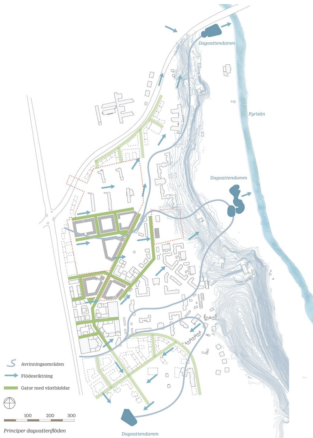
Bild 75 Bilden visar avrinningsområden inom Ulleråker. Blå pilar visar flödesriktningen för dagvatten och till vilken dagvattendamm vattnet leds. Illustration Nivå landskapsarkitektur
