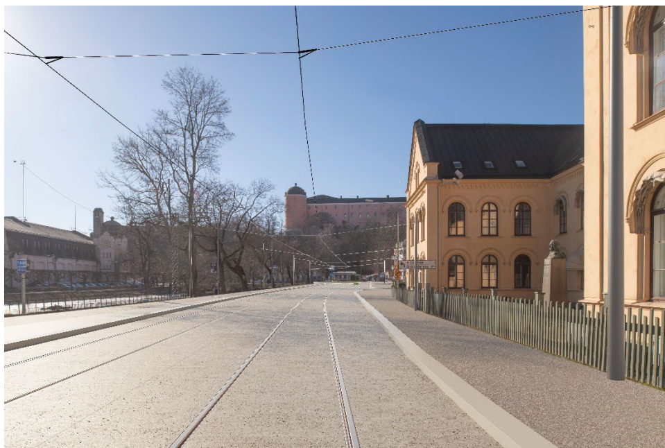
Figur 17 Illustrationen visar ett exempel på hur spårväg med kontaktledningsstolpar i gatans ytterkanter kan komma att se ut längs Munkgatan, intill byggnadsminnet gamla Anatomicum. I fonden syns Uppsala slott. Exakt placering av stolpar behöver studeras i kommande detaljprojektering. (Visionsbild: White arkitekter)
