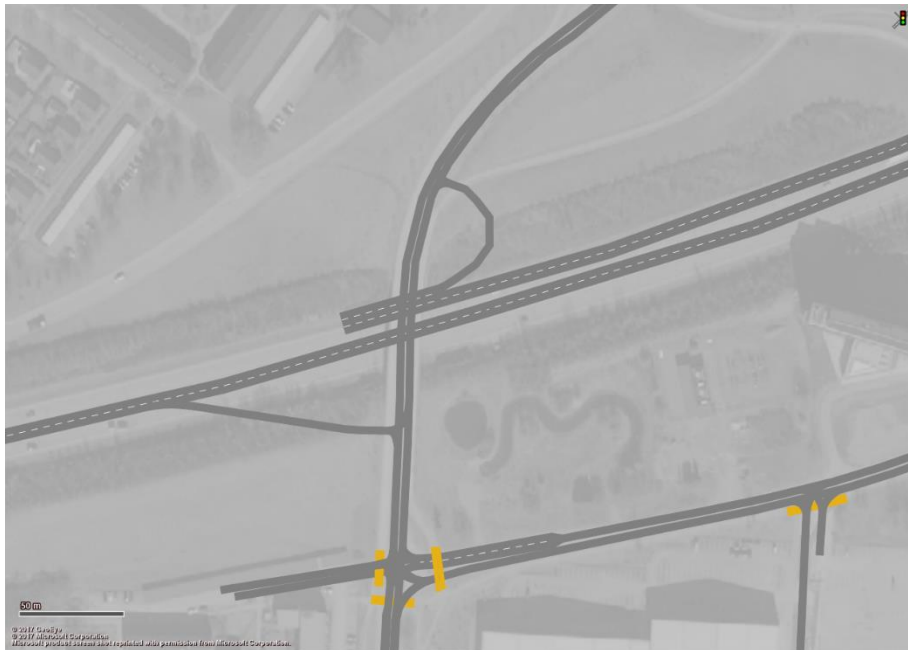
Figur 24. Nya ramper mellan Bärbyleden och Råbyvägen.
